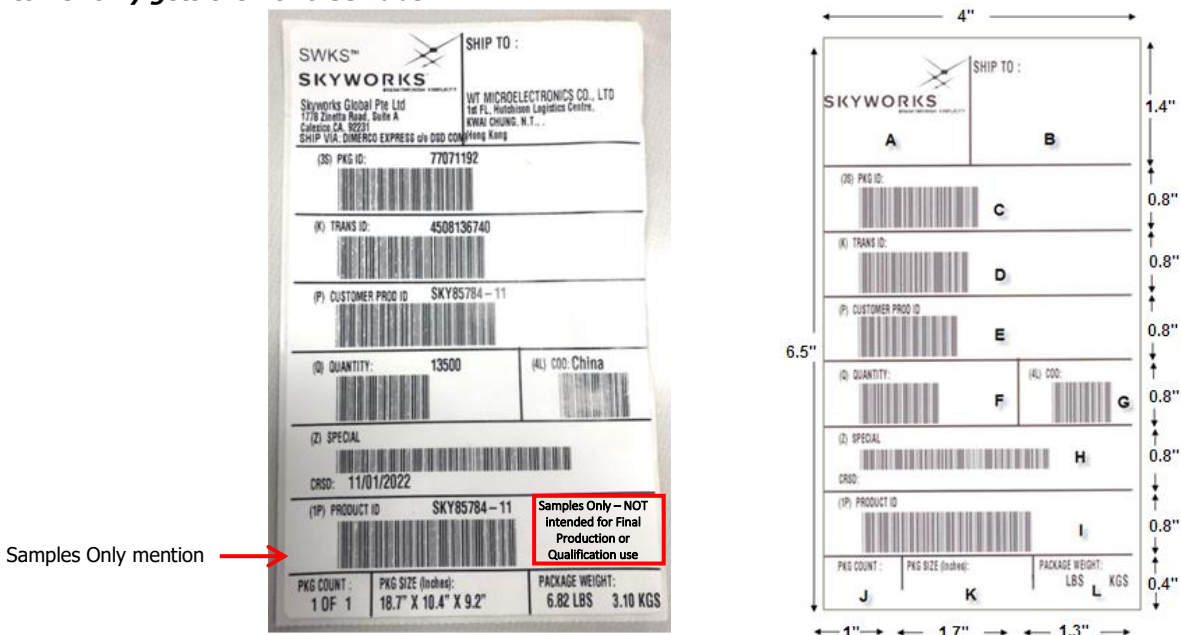
Figure 3: Shipping Container (3s) Label and Dimensions Figura 3: Etiqueta del Contenedor de Envío (3S) y Dimensiones
